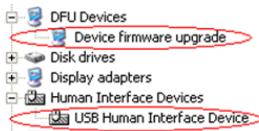
图 14. 设备管理器中的 DFU 设备和人机接口设备
